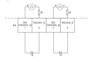
$U_f$ =1,5V;  $I_f$  min.=1mA;  $I_f$  max.=50mA
