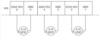
Analog or PWM (max. 30kHz);  $R_{in}$  = min. 8 k $\Omega$ ; U(V) - voltage
