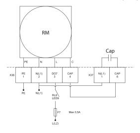
RM - rotor motor; Cap - capacitor
