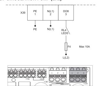
6.5.8. POWER SUPPLY CONNECTION TO FREON COOLER (EX2)
