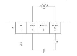
$R=1k\Omega$ ;  $U_f=1,5V$ ;  $I_f$  min.=1mA;  $I_f$  max.=50mA
